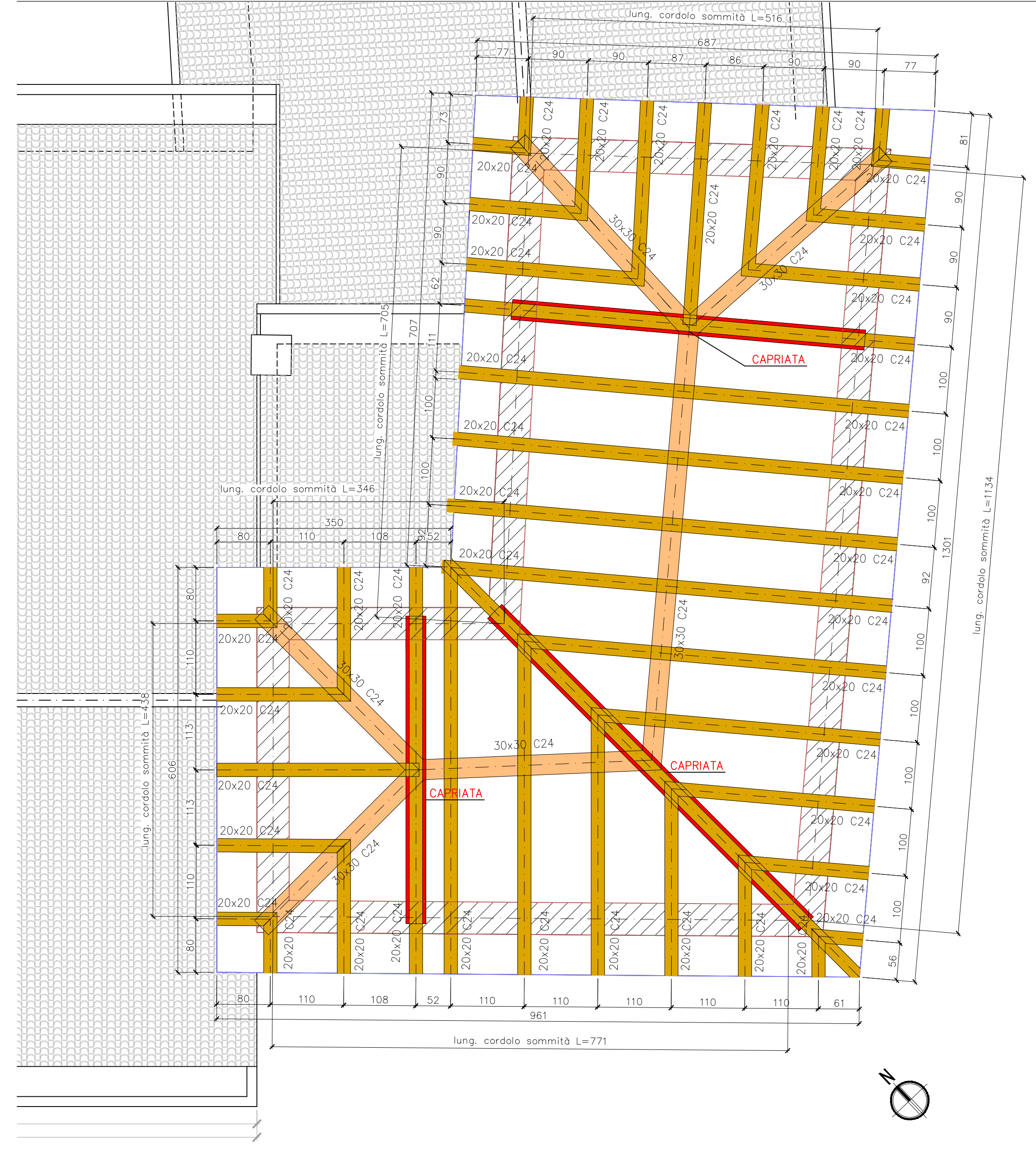
PIANTA COPERTURA scala 1:50
